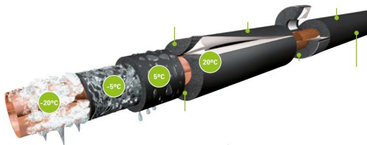
Imagen 25. Esquema del aislamiento térmico con coquilla elastomérica de una tubería.
